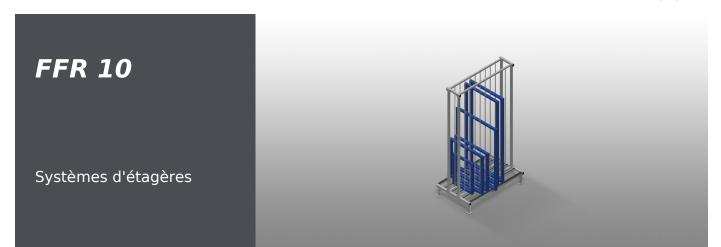
Etagère pour le stockage des éléments de fenêtre. Construction en acier stable. Etagère pour le stockage des vantaux de fenêtre. Les éléments sont disponibles directement de manière individuelle. Développé spécialement pour l'intégration sur les lignes de montage. Accès possible de deux côtés. Surface de contact avec convoyeur à rouleaux porteurs simplifiant le chargement/déchargement. Barres de séparation de cases revêtues d'un tuyau de protection.
