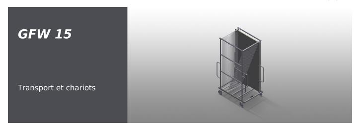
Construction en acier stable. Idéal pour le tri du verre. Pour le transport de vitrages à l'intérieur de l'entreprise. Séparateur pour 15 vitres. Accès possible de deux côtés. La surface de contact est recouverte de profil caoutchouc. Séparateur avec protection plastique. Etrier de transport sur deux faces pour le déplacement. Deux roulettes de direction et deux roues fixes.
