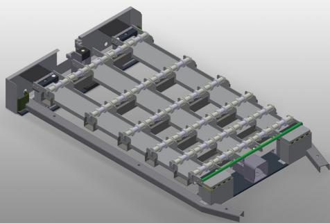
Manipulation simple des vitrages associée au chariot de transport à vitrages GFW 15. Avec dispositif de levage pneumatique, contrôlable à l'aide d'un clapet de pied, course maximum = 50 mm. Transporteurs à roulettes inférieurs équipé d'un total de 15 x 4 roulettes PVC. Complet avec aide à l'entrée pour les chariots de transport à vitrages GFW 15. Dimensions de base : 2.100 x 1.250 mm.
