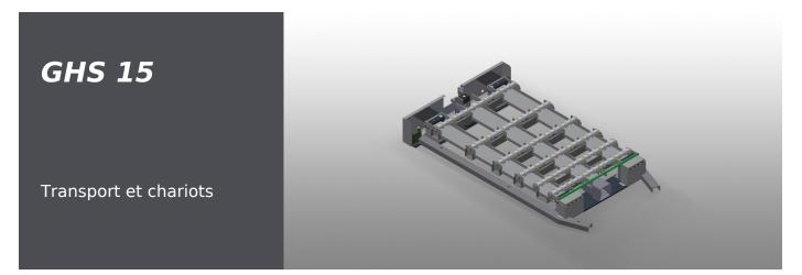
Manipulation simple des vitrages associée au chariot de transport à vitrages GFW 15. Avec dispositif de levage pneumatique, contrôlable à l'aide d'un clapet de pied, course maximum = 50 mm. Transporteurs à roulettes inférieurs équipé d'un total de 15 x 4 roulettes PVC. Complet avec aide à l'entrée pour les chariots de transport à vitrages GFW 15. Dimensions de base : 2.100 x 1.250 mm.
