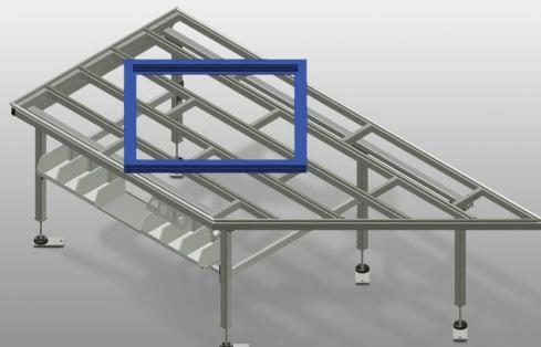
Table horizontale pour tous les travaux sur le cadre et le vantail. Construction en acier stable. Table de travail inclinée utilisée pour le passage dans la ligne de fabrication ou la zone tampon. Table d'assemblage pour tous les travaux sur le cadre et le vantail. Support de table à glissières PVC. Tablette pour rangement des outils et des accessoires. Réglable en hauteur. Montage simple dans le système modulaire.
