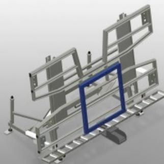
Table d'assemblage pour le montage vertical et horizontal. Construction en acier stable. Important lors du passage du transport vertical vers le transport horizontal et inversement. Idéal pour montage vertical et horizontal. Basculement pneumatique. Support de table à glissières PVC. Support à rouleaux à abaissement pneumatique. Raccord d'air comprimé quadruple.
