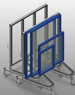
Chariot de commissionnement pour transports à l'intérieur de l'entreprise des éléments de fenêtre. Construction en acier stable. Pour transports à l'intérieur de l'entreprise. Support de profilé à revêtement caoutchouc. A l'état non chargé, emboîtables de manière à réduire l'espace de stockage requis. 4 roulettes de direction, dont 2 à frein de blocage.
