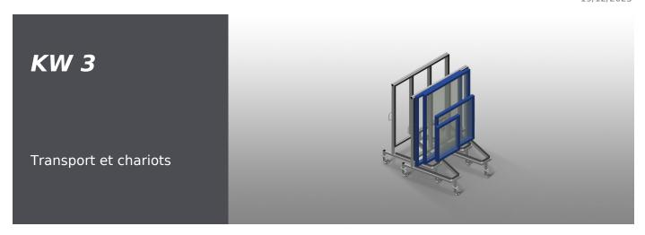
Chariot de commissionnement pour transports à l'intérieur de l'entreprise des éléments de fenêtre. Construction en acier stable. Pour transports à l'intérieur de l'entreprise. Support de profilé à revêtement caoutchouc. A l'état non chargé, emboîtables de manière à réduire l'espace de stockage requis. 4 roulettes de direction, dont 2 à frein de blocage.
