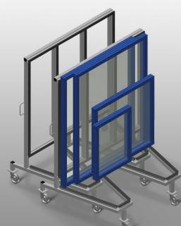
Chariot de commissionnement pour transports à l'intérieur de l'entreprise des éléments de fenêtre. Construction en acier stable. Pour transports à l'intérieur de l'entreprise. Support de profilé à revêtement caoutchouc. A l'état non chargé, emboîtables de manière à réduire l'espace de stockage requis. 4 roulettes de direction, dont 2 à frein de blocage.
