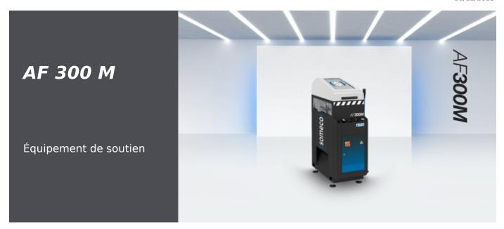
Grugeuse en bout horizontale à avance manuelle. Fraisage en biais à  $+45^{\circ}$  /  $90^{\circ}$  /  $-45^{\circ}$ . Changement rapide du groupe de fraisage assuré par commande pneumatique. Table de travail anti-rayures. Protection intégrale de la zone d'usinage.
