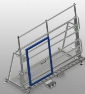
Support d'assemblage pour montage vertical. Construction en acier stable. Idéal pour montage vertical. Adapté pour les lignes. Positions intermédiaires progressives pour un travail ergonomique. Réglage en hauteur à vérin pneumatique. Support à rouleaux à roue en acier. Support de table à glissières PVC. 2 dispositifs de serrage du profilé à décalage horizontal. Raccord d'air comprimé quadruple.
