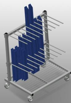
Chariot de profilé pour le stockage et le transport verticaux des profilés. Construction en acier stable. Transport de profilé vertical. Chariot de profilés à chargement sur un côté. Chargement et déchargement simples. Suffisant pour 30 - 40 Profilés. Séparateurs réglables en hauteur. Surface d'installation sous forme de fond en grille de barres. 4 roulettes de direction, dont 2 à frein de blocage.
