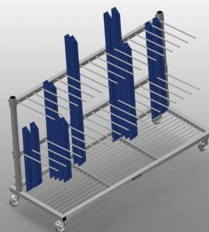
Chariot de profilé pour le stockage et le transport verticaux des profilés. Construction en acier stable. Transport de profilé vertical. Chariot de profilés à chargement sur un côté. Chargement et déchargement simples. Suffisant pour 60 - 80 Profilés. Séparateurs réglables en hauteur. Surface d'installation sous forme de fond en grille de barres. 4 roulettes de direction, dont 2 à frein de blocage.
