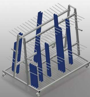
Chariot de profilé pour le stockage et le transport verticaux des profilés. Construction en acier stable. Transport de profilé vertical. Chariot de profilés à chargement sur deux côtés. 18 compartiments par face. Chargement et déchargement simples. Capacité de 120 - 160 barres de profilés. Séparateurs réglables en hauteur. Surface d'installation sous forme de fond en grille de barres. 4 roulettes de direction, dont 2 à frein de blocage.
