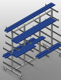
Chariot de profilé pour le stockage et le transport horizontaux des profilés. Construction en acier stable. Transport de profilé horizontal. Bras supports recouverts de caoutchouc. Chariot de profilés à support de profilés sur deux côtés. 6 rangements par support. 2 supports médians. 4 roulettes de direction, dont 2 à frein de blocage.
