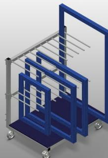
Chariot de profilé pour le transport à l'intérieur de l'entreprise des cadres et des vantaux. Construction en acier stable. Chariot à peigne de tri pour le transport et le stockage des cadres et des vantaux. Support en bois dur. Séparateurs pour 9 cadres. Séparateurs réglables en hauteur. 4 roulettes de direction, dont 2 à frein de blocage.
