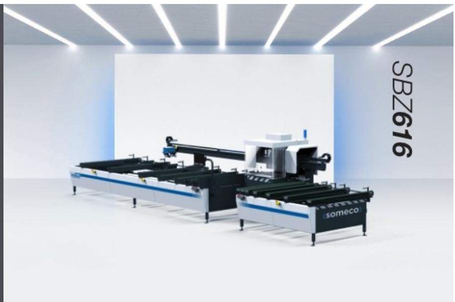
Le centre de coupe peut être utilisé pour la coupe automatique. L'unité de coupe à axe contrôlé garantit une vitesse d'usinage maximum pour un niveau de qualité optimal. Centre de coupe avec angles de coupe programmables, coupe de profils sur mesure pour la production de fenêtres, portes et murs-rideaux.
