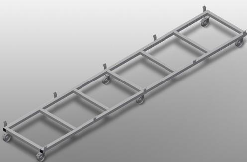
Construction en acier stable. Chariots de transport de cassettes de profilés. Idéal pour le transport de cassettes de profilés du magasin à la scie ou au centre d'usinage. Pour les palettes de profilé jusqu'à 760 mm de large. Pattes de fixation pour le blocage des palettes. Six roulettes, quatre roulettes de direction à frein de blocage et deux roues fixes.
