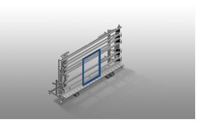
Unité de contrôle et de vitrage pour le vitrage et le contrôle final dans la fabrication individuelle et de série. Montage rapide et précis des fenêtres, portes et éléments. Précision grâce au serrage parallèle des barres. Construction en acier stable. Réglage progressif de la hauteur. Manipulation simple par interrupteur à pédale. 2 barres de serrage pneumatiques rabattables et déplaçables et raccord d'air comprimé quadruple.
