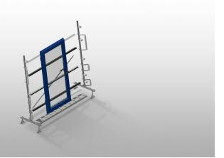
Convoyeur à rouleaux vertical pour le transport et le stockage des éléments de fenêtre. Construction en acier stable. Extension dans le système modulaire. Convoyeur à rouleaux vertical pour le transport et le stockage continus des éléments de fenêtre. Manipulation simple des éléments de fenêtre. Chaque unité de convoyeur à rouleaux 2.000 mm de long. Glissières PVC haut et bas. Trois convoyeurs à roulettes caoutchouc, diamètre 50 mm. Unité de base sans support d'extrémité.
