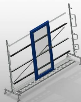
Convoyeur à rouleaux vertical pour le transport et le stockage des éléments de fenêtre. Construction en acier stable. Extension dans le système modulaire. Convoyeur à rouleaux vertical pour le transport et le stockage continu des éléments de fenêtre. Manipulation simple des éléments de fenêtre. Chaque unité de convoyeur à rouleaux 3.000 mm de long. Glissières PVC haut et bas. Trois convoyeurs à roulettes caoutchouc, diamètre 50 mm. Unité de base sans support d'extrémité.
