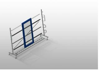
Convoyeur à rouleaux vertical pour le transport et le stockage des éléments de fenêtre. Construction en acier stable. Extension dans le système modulaire. Convoyeur à rouleaux vertical pour le transport et le stockage continus des éléments de fenêtre. Manipulation simple des éléments de fenêtre. Chaque unité de convoyeur à rouleaux 3.000 mm de long. Glissières PVC haut et bas. Trois convoyeurs à roulettes caoutchouc, diamètre 50 mm. Unité de base sans support d'extrémité.
