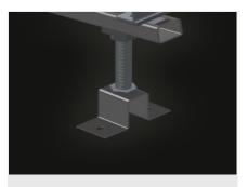
Réglage en hauteur du convoyeur à rouleaux
