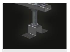
Réglage en hauteur du convoyeur à rouleaux
