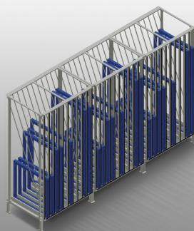
Regal für die Lagerung von Fensterelementen. Stabile Stahlkonstruktion. Vertikales Flügelpufferregal zum Einsortieren der Flügelemente. Pufferregal mit zehn Fächern. Schneller Zugriff zu den Elementen. Kunststoffüberzogene Fachteilrohre. Anlagefläche mit Kunststoffplatte. Spezielle Gleitblech-Auflage ermöglicht eine ergonomische Entnahme der Flügelemente nach Bedarf.
