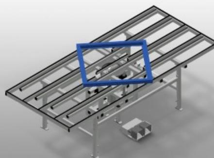
Hebe-Drehtisch für Montage und Dichtungseinzug. Stabile Stahlkonstruktion. Ideal für Montage und Dichtungseinzug. In der Höhe justierbar. Innentisch pneumatisch höhenverstellbar. Innentisch drehbar mit pneumatischer Feststellbremse. Innentisch mit Gummileisten. Außentisch mit Kunststoff-Gleitleisten. Druckluftanschluss 4-fach.
