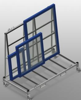
Kommissionswagen für innerbetrieblichen Transport der Fensterelemente. Stabile Stahlkonstruktion. Wagen für innerbetriebliche Transporte. Aufnahme für Staplertransport. Vier Haken für Krantransport. Vier Zurrurthalter. Profilauflage mit Gummibelag. Lenkrollen abnehmbar, dadurch sicherer Stand des Kommissionswagens auf dem Boden. Vier Lenkrollen, davon zwei mit Feststellbremse.
