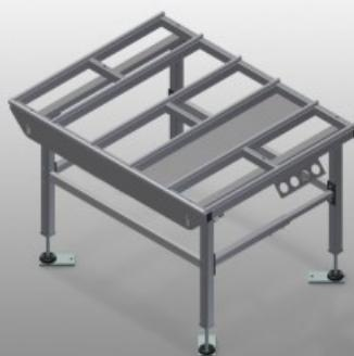
Mesa horizontal para todos los trabajos en marcos y hojas. Construcción estable de acero. Superficie de apoyo de la mesa con barras deslizantes de plástico. Bandeja de almacenamiento para depositar herramientas y accesorios. Altura regulable. Instalación sencilla con un diseño de sistema modular.
