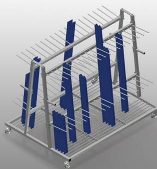
Carro de perfiles para el almacenamiento y transporte vertical de perfiles. Construcción estable de acero. Transporte vertical de perfiles. El carro de perfiles se puede cargar por ambos lados. 18 compartimentos por lado. Fácil carga y descarga. Suficiente para 120 - 160 barras de perfil. La altura de los separadores de los compartimentos es ajustable. Superficie de apoyo con suelo de rejilla para barras. Cuatro ruedas, dos de ellas con freno de fijación.
