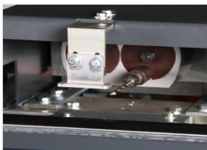
**Unité de perçage des pivots d'angles (Optionnel)**
