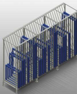
Etagère pour le stockage des éléments de fenêtre. Construction en acier stable. Étagère tampon de vantaux verticale pour le tri des éléments des vantaux. Étagère tampon à 10 compartiments. Accès rapide aux éléments. Tuyaux de pièces recouvertes de plastique. Surface de contact avec plaque plastique. Le support spécial pour tôle coulissante permet un prélèvement ergonomique des éléments de vantail, en fonction des besoins.
