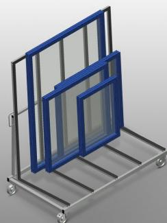
Chariot de commissionnement pour transports à l'intérieur de l'entreprise des éléments de fenêtre. Construction en acier stable. Pour transports à l'intérieur de l'entreprise. Support de profilé à revêtement caoutchouc. 4 roulettes de direction, dont 2 à frein de blocage.
