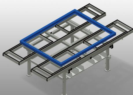
Table d'assemblage extensible pour tous les travaux sur le cadre et le vantail. Construction en acier stable. Table d'assemblage universelle. Extensible sur 4 côtés. Idéal pour les grands éléments. Réglable en hauteur. Support de table à glissières PVC. Rangement pratique en dessous de la table. 4 bacs PVC pour petits accessoires, ferrures et vis. Raccord d'air comprimé quadruple. Montage simple dans le système modulaire.
