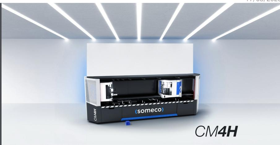
铣床专门设计用于对 45° 角预切的 PVC 型材进行轮廓加工。该铣床与配备了无缝技术反凸模具的 Someco SM 系列机床共同集成到窗户生产流程当中、对型材进行轮廓加工、为随后的无缝焊接阶段做准备。CM 4H 配备两个操作单元：左侧为固定单元、右侧为移动单元。每个单元都有三个独立轴、并控制三个电动主轴（一个用于控制端面铣刀、另两个用于控制两个相同直径的铣刀）。这款机床可以对两根棒材的四个面同时进行加工、生产效率相当于四头焊接机。可以直接通过机床控制台完成编程、也可以导入并执行经过办公室优化的预定义加工清单。
