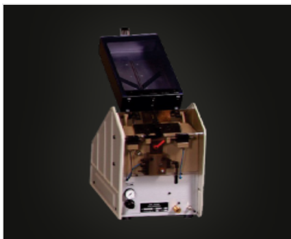
螺钉输送装置 FAZ 2800 带自动螺钉进给运作的自动进给螺丝机
