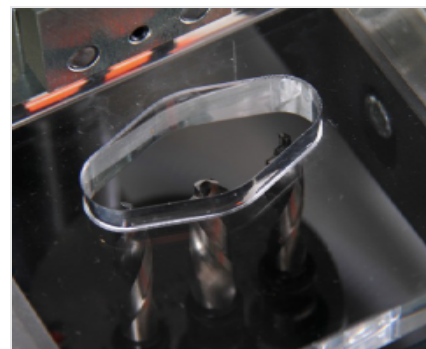
执手孔钻孔装置 FAZ 2800 (选修的) 固定式执手孔钻孔装置集成有液压气动进给和夹紧装置并且配备三轴钻头
