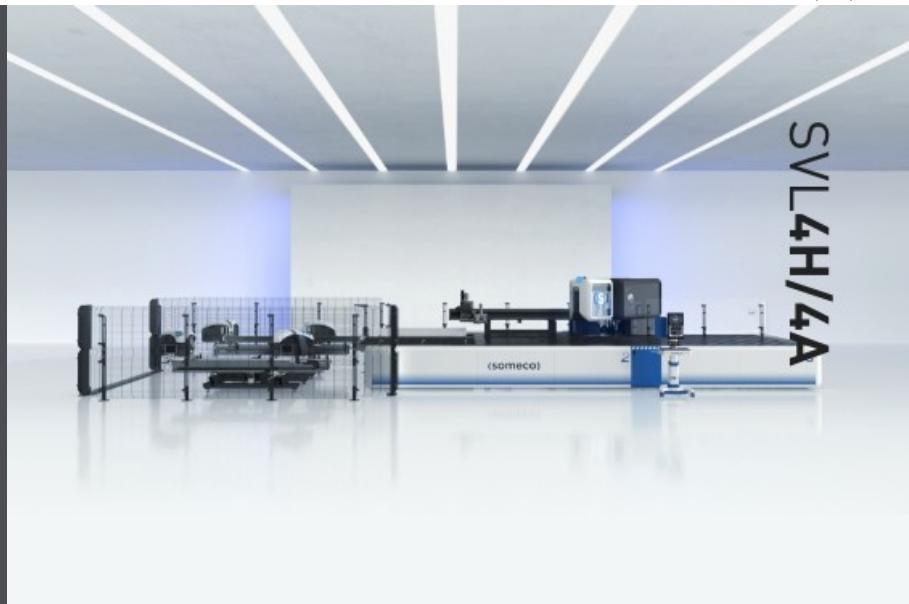
用于 PVC 型材的 SVL 4H/4A 焊接和清理生产线、由 5 个重要工位组成的：备有框架拔出装置的 SM 4H 水平焊接机（有不同型号）、冷却台、旋转台、4 周的清理机（EV 4A）和拔出专用台。所有工位的供料是双方的、可以选择从右边或左边供料。这样，在设定机器的工作配置时、可以选择工作方向。根据生产线所安装的焊接机、SVL 4H/4A 可以自动地控制不同尺寸框架的加工过程。通过适当配置、该生产线可以加工标准、牙科利、涂料等型材。
