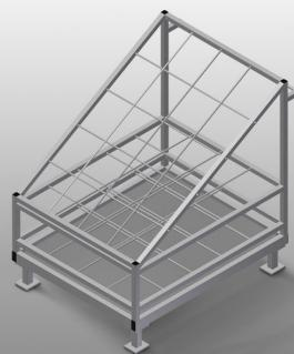
Ripiano per la disposizione classificata di profili di armatura ritroncati. Solida struttura in acciaio. Immagazzinaggio in verticale di profili in acciaio. Dimensioni esterne ridotte. Disposizione ordinata dei profili per lunghezze fisse. Trasportabile tramite carrello elevatore.
