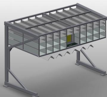
Scaffale ferramenta con 36 scomparti per il riponimento ordinato delle ferramenta sulla postazione di montaggio delle ante. Solida struttura in acciaio. Con sei supporti angolari per testate di rinvio angolari. Alloggiamento per monitor e supporto per tastiera.
