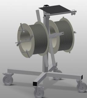
Carrello per guarnizioni per l'alloggiamento di rotoli di guarnizioni. Solida struttura in acciaio. Alloggiamento per due bobine. Indispensabile nell'inserimento delle guarnizioni. Possibilità di impostare il diametro di ciascuna bobina. Ripiano utensili. Quattro ruote orientabili, due delle quali con freno fisso.
