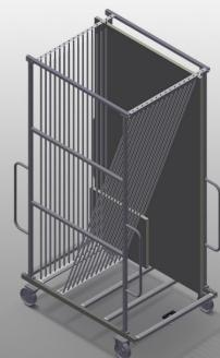
Solida struttura in acciaio. Ideale per classificare i vetri. Per trasportare lastre di vetro all'interno dell'azienda. Separatori per 15 lastre di vetro. Accesso possibile su entrambi i lati. Superficie di appoggio rivestita di un profilo in gomma. Separatori con protezione in PVC. Staffa di trasporto spostabile su due lati. Due ruote orientabili e due ruote fisse.
