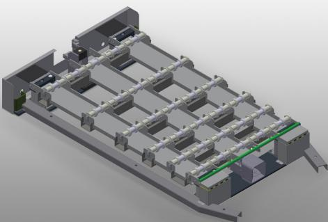
Facile spostamento dei vetri in combinazione con il carrello portavetro GFW 15. Con dispositivo di sollevamento pneumatico, comandabile tramite valvola a pedale, sollevamento massimo = 50 mm. Rulliere inferiori dotate di un totale di 15 x 4 rulli in PVC. Completo di guida di inserimento per il carrello portavetro GFW 15. Dimensioni della base: 2.100 x 1.250 mm.
