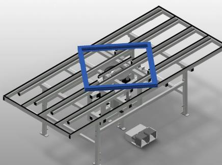
Tavolo di sollevamento girevole per il montaggio e l'inserimento delle guarnizioni. Solida struttura in acciaio. Ideale per il montaggio e l'inserimento delle guarnizioni. Regolabile in altezza. Banco interno regolabile in altezza pneumaticamente. Banco interno girevole con freno fisso pneumatico. Banco interno con listelli in gomma. Banco esterno con listelli scorrevoli in PVC. Attacco dell'aria compressa quadruplo.
