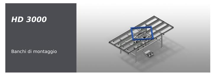
Tavolo di sollevamento girevole per il montaggio e l'inserimento delle guarnizioni. Solida struttura in acciaio. Ideale per il montaggio e l'inserimento delle guarnizioni. Regolabile in altezza. Banco interno regolabile in altezza pneumaticamente. Banco interno girevole con freno fisso pneumatico. Banco interno con listelli in gomma. Banco esterno con listelli scorrevoli in PVC. Attacco dell'aria compressa quadruplo.
