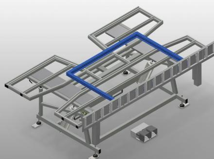
Banco di montaggio per il montaggio verticale e orizzontale. Solida struttura in acciaio. Importante nel passaggio dal trasporto verticale a quello orizzontale e viceversa. Ideale per il montaggio verticale e orizzontale. Ribaltabile pneumaticamente. Supporto del tavolo con listelli scorrevoli in PVC. Supporto a rulli abbassabile pneumaticamente. Attacco dell'aria compressa quadruplo.
