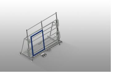
Banco di montaggio per il montaggio verticale. Solida struttura in acciaio. Ideale per il montaggio verticale. Adatto a linee. Posizioni intermedie regolabili in continuo per l'ergonomia del lavoro. Regolazione dell'altezza con cilindro pneumatico. Supporto a rulli con rulli in acciaio. Supporto del tavolo con listelli scorrevoli in PVC. Due serraprofili spostabili in orizzontale. Attacco dell'aria compressa quadruplo.
