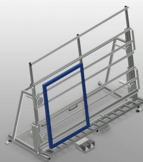
Banco di montaggio per il montaggio verticale. Solida struttura in acciaio. Ideale per il montaggio verticale. Adatto a linee. Posizioni intermedie regolabili in continuo per l'ergonomia del lavoro. Regolazione dell'altezza con cilindro pneumatico. Supporto a rulli con rulli in acciaio. Supporto del tavolo con listelli scorrevoli in PVC. Due serraprofili spostabili in orizzontale. Attacco dell'aria compressa quadruplo.
