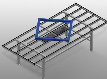
Banco di montaggio estraibile per tutti i lavori su telai e ante. Solida struttura in acciaio. Banco di montaggio per tutti i lavori su telai e ante. Trasporto dei telai orizzontale. Piano di appoggio per riporre utensili e accessori. Regolabile in altezza. Supporto del tavolo con listelli scorrevoli in PVC. Facilità di montaggio in un sistema modulare.
