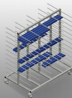
Carrello per l'immagazzinaggio orizzontale e il trasporto di profili. Solida struttura in acciaio. Trasporto dei profili orizzontale. Carrello con ripiani per profili sui due lati. Dodici ripiani per montante. Quattro ruote orientabili, due delle quali con freno fisso.
