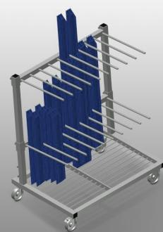
Carrello per l'immagazzinaggio verticale e il trasporto di profili. Solida struttura in acciaio. Trasporto dei profili verticale. Su un solo lato rispetto al carrello da caricare. Facili operazioni di carico e scarico. Sufficiente per 30-40 barre di profili. Separatori regolabili in altezza. Superficie d'appoggio in forma di rastrelliera per barre. Quattro ruote orientabili, due delle quali con freno fisso.
