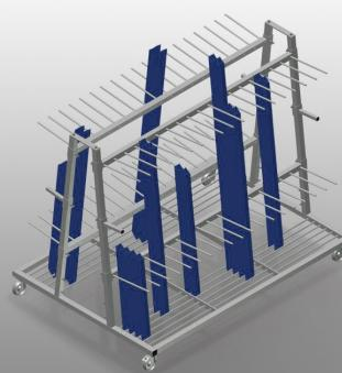
Carrello per l'immagazzinaggio verticale e il trasporto di profili. Solida struttura in acciaio. Trasporto dei profili verticale. Su due lati rispetto al carrello da caricare. 18 scomparti per lato. Facili operazioni di carico e scarico. Sufficiente per 120-160 barre di profili. Separatori regolabili in altezza. Superficie d'appoggio in forma di rastrelliera per barre. Quattro ruote orientabili, due delle quali con freno fisso.
