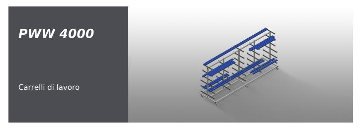
Carrello per l'immagazzinaggio orizzontale e il trasporto di profili. Solida struttura in acciaio. Trasporto dei profili orizzontale. Trasporto facile per il materiale delle barre e i ritagli di profili. Bracci di supporto rivestiti in gomma. Carrello con ripiani per profili sui due lati. Sei ripiani per montante. Tre montanti centrali. Sei ruote orientabili, due delle quali con freno fisso.
