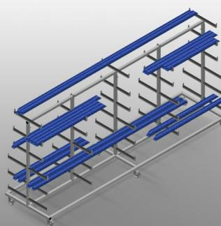
Carrello per l'immagazzinaggio orizzontale e il trasporto di profili. Solida struttura in acciaio. Trasporto dei profili orizzontale. Trasporto facile per il materiale delle barre e i ritagli di profili. Bracci di supporto rivestiti in gomma. Carrello con ripiani per profili sui due lati. Sei ripiani per montante. Tre montanti centrali. Sei ruote orientabili, due delle quali con freno fisso.
