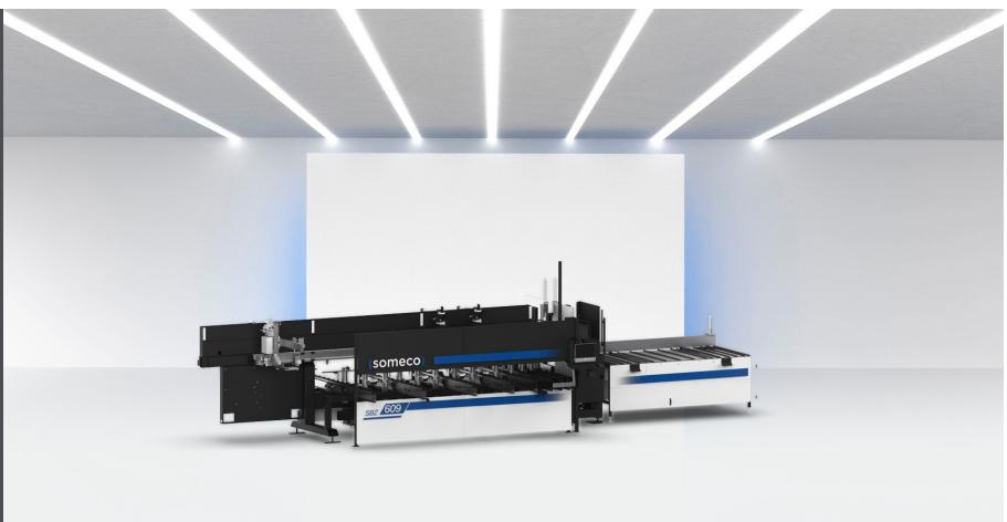
Centro di lavoro per avvitare rinforzo, forare e frescare profili pretagliati per la costruzione di finestre e porte con e senza armatura in acciaio. Realizzato in versione portale per grosse sezioni di profili e per processi ottimizzati. Aumento dell'efficienza grazie alla lavorazione parallela dell'avvitatore per rinforzi esterno.
