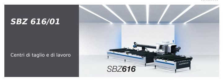
Il centro di taglio può essere utilizzato per il taglio automatico. L'unità di taglio ad asse controllato garantisce la velocità di lavoro massima al miglior livello di qualità. Centro di taglio con angoli di taglio programmabili, taglio di profili a misura per la produzione di finestre, porte e facciate continue.
