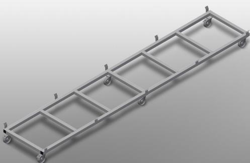
Solida struttura in acciaio. Carrello di trasporto per la movimentazione di cassette di profili. Ideale per trasportare le cassette di profili dal magazzino alla troncatrice o al centro di lavoro. Per pallet di profili larghi fino a 760 mm. Passanti di sicurezza per il fissaggio del pallet. Sei ruote, quattro orientabili con freno fisso e due fisse.
