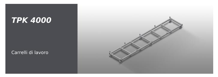
Solida struttura in acciaio. Carrello di trasporto per la movimentazione di cassette di profili. Ideale per trasportare le cassette di profili dal magazzino alla troncatrice o al centro di lavoro. Per pallet di profili larghi fino a 760 mm. Passanti di sicurezza per il fissaggio del pallet. Sei ruote, quattro orientabili con freno fisso e due fisse.
