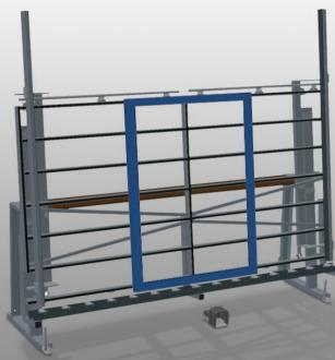
Unità per vetratura e controllo finale. Montaggio rapido ed esatto di finestre, porte ed elementi. Solida struttura in acciaio. Precisione grazie alla pressatura parallela delle barre di serraggio orientabili manualmente. Facile da manovrare tramite pedale. Centraggio pneumatico, ripiano per utensili e attacco dell'aria compressa quadruplo.
