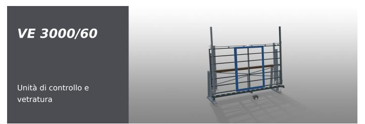
Unità per vetratura e controllo finale. Montaggio rapido ed esatto di finestre, porte ed elementi. Solida struttura in acciaio. Precisione grazie alla pressatura parallela delle barre di serraggio orientabili manualmente. Facile da manovrare tramite pedale. Centraggio pneumatico, ripiano per utensili e attacco dell'aria compressa quadruplo.
