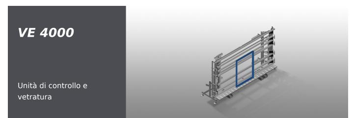
Unità di controllo e vetratura per la vetratura e il controllo finale nella produzione singola e di serie di ante. Montaggio rapido ed esatto di finestre, porte ed elementi. Precisione grazie alla pressatura parallela delle barre di serraggio. Solida struttura in acciaio. Altezza regolabile in continuo. Facile da manovrare tramite pedale. Due barre di serraggio ribaltabili e spostabili pneumaticamente e attacco dell'aria compressa quadruplo.
